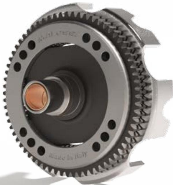
La nuova trasmissione primaria è inoltre completamente smontabile per poter accedere ai parastrappi e poter cambiare le sue molle. È infatti possibile utilizzare diversi set di molle in modo da modificare la risposta dei parastrappi a seconda delle varie applicazioni e di quanto desiderato. La cura ai dettagli è tale da aver richiesto la produzione di nuove viti di accoppiamento campana-ingranaggio progettate appositamente per questo particolare meccanico.
