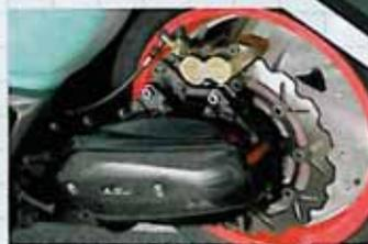
リアブレーキまわりも完璧。bremboの4POTを285φの大径ウェーブディスクと組み合わせた。また、ブレーキカバー部分もカーボンを用いてトータルコーディネートにも徹底している。
