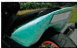
発生製のテールカウルにナンバーをピンタリフィット。さらにLEDでテールランプ類を超薄コンパクトに取り付け、デザインを壊さないよう加工している。
