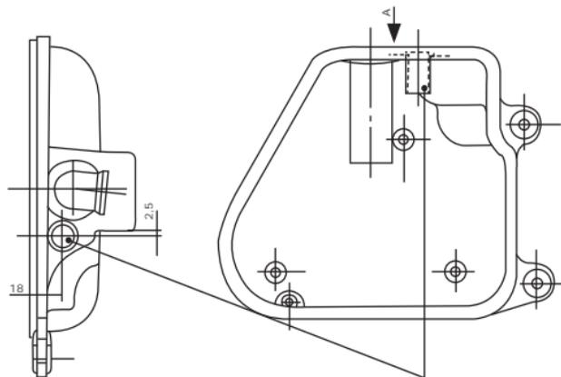
Praticare nella cassetta filtro aria un foro di mm 13,75 esattamente nel punto indicato nel disegno per inserirci il tubetto silenziatore calibrato per aumentare la portata d'aria al motore. Collegare le relative trasmissioni gas e avviamento accertandosi del perfetto funzionamento dei comandi.
