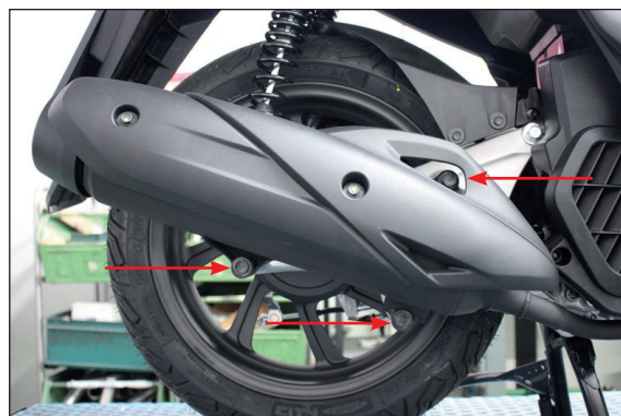
Svitare le viti indicate (3) e rimuovere l'impianto di scarico originale Unscrew the indicated screws (3) and remove the original exhaust system
