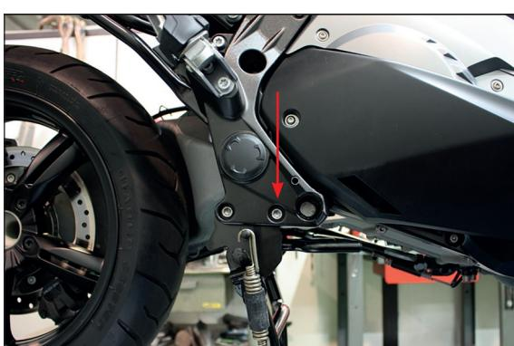
Sostituire la vite indicata con la TCEI M8x40mm fornita
