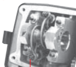
Viti di registro Valve Adjustment Screw Ventil-Einstellschraube
